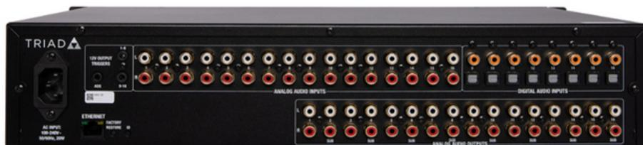
Los conmutadores de matriz de audio Triad de 16 × 16 brindan audio de alta resolución en toda la casa con un potente DSP completamente nuevo y compatibilidad con OvrC. Con un ecualizador a nivel de altavoz y un ecualizador a nivel de habitación, estos interruptores brindan un sonido preciso en cualquier espacio.
